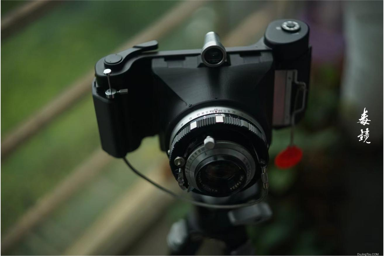
整体来说这套打印的快拍机，给了新闻机用户很便捷的改装方案，可以无损，并且精准兼容的方式变成一台快拍机。重量大幅度减轻了，但是还是很沉的，因为 马米亚这个后背和镜头重量就很可观了，颜值增加了不少，这个快拍机可以放三个配件到冷靴位置，中间放置一个取景器，但是之后如果想装传统的测距仪由于空间不够基本都装不上，比较实用的是可以装个水平仪，我订购了两个还没到。目前就用一个取景器，测试了一下取景基本很准。
